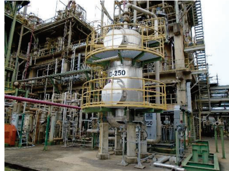
ภาพที่ 2-26 Hydrogenation Drum
